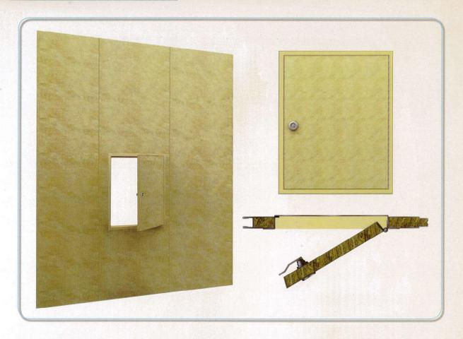
壁板检修门主要用于维修区。检修门以门框固定在25mm或者50mm 的壁板上,门扇与门框用铰链相连,检修时用通用钥匙打开即可。门框的 装饰为喷漆,颜色与壁板相近,门扇装饰面为PVC膜,颜色与壁板相同, 当检修门高度≥500时,门锁为两个,当检修门高度<500mm时,门锁为 一个。
