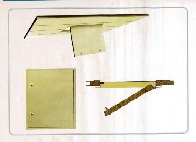
天花板检修门主要应用于天花板上的维修区。检修门以门框固定在25mm或者50mm厚的天花板上,门扇与门框用铰链相连,检修时用螺丝刀打开。检修门门框的装饰面为喷漆,颜色与天花板相近,门扇装饰面为PVC膜,颜色与天花板相同,当检修门尺寸>200时,检修门锁为两个,当检修门尺寸为≤200mm时检修门锁为一个。
